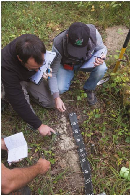
Illustration 3 : Description de sol après sondage à la tarière pédologique (a) et sur fosse (b).
