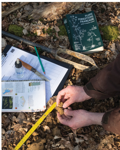
Illustration 5 : Réalisation en forêt d'un sondage du sol à la tarière.
