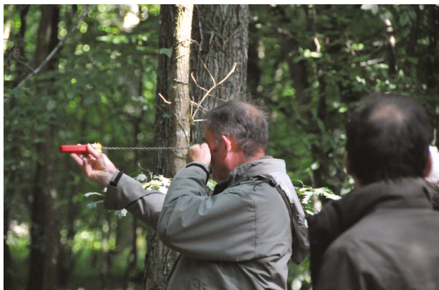
Illustration 5 : Mesure de la surface terrière d'un peuplement, un élément du diagnostic forestier.
