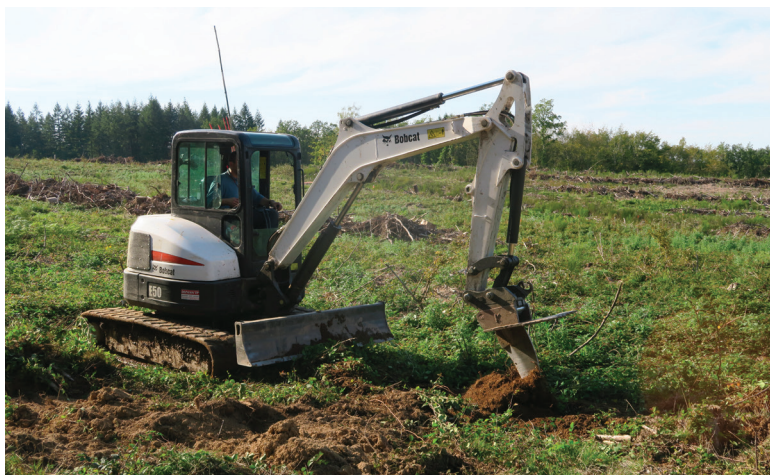
Illustration 11 : Préparation mécanisée du site avec une minipelle munie d'un Sous-soleur multifonctions®.
